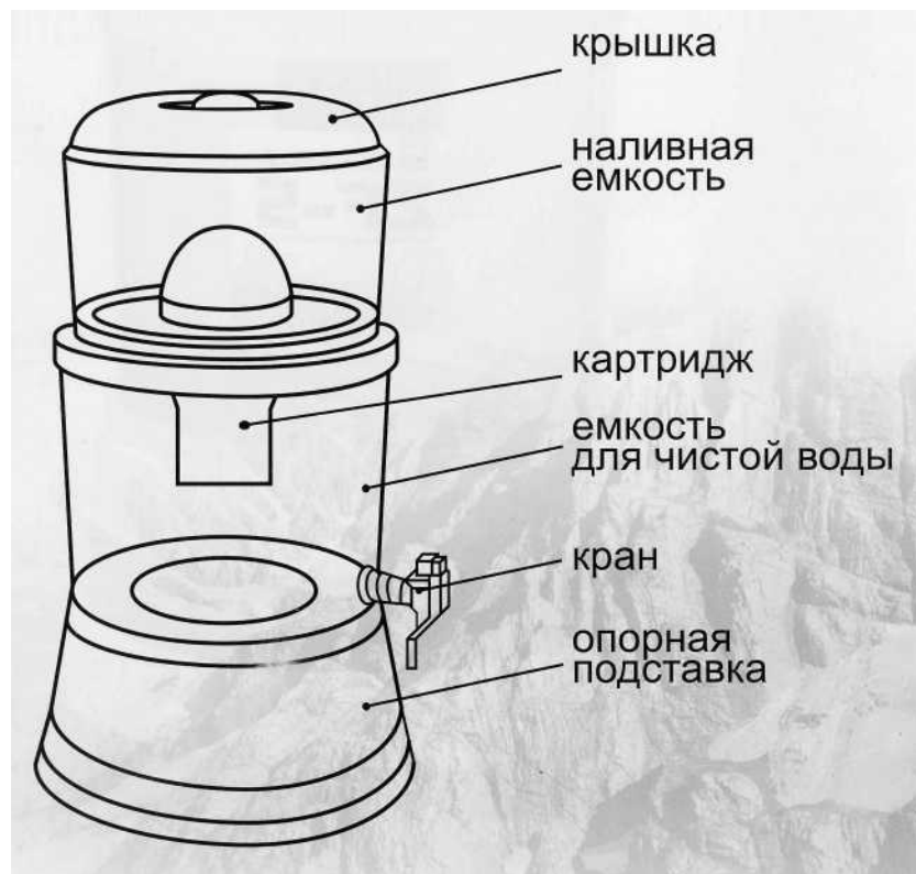
Рис. 1. Устройство фильтра «Золотая Формула ZF-5»
